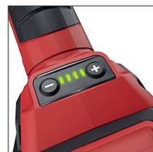
Avec maintien constant de la vitesse de rotation et 4 niveaux de vitesse, affichage bien visible par LED. (uniquement LBE 125 18.0-EC)
